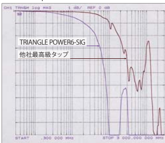
▲HP社 Network Analyzer 高周波基準ノイズ信号をインレットからタップに入力し、コンセントから出力されたノイズ信号を測定。タップを通してノイズがどれだけ減衰するかを測定。
