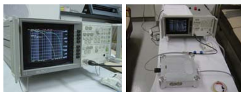
▲HP社 Network Analyzer 高周波基準ノイズ信号をインレットからタップに入力し、コンセントから出力されたノイズ信号を測定。タップを通してノイズがどれだけ減衰するかを測定。
