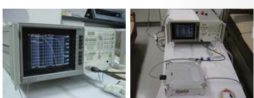
▲HP社 Network Analyzer 高周波基準ノイズ信号をインレットからタップに入力し、コンセントから出力されたノイズ信号を測定。タップを通すことでノイズがどれだけ減衰するかを測定。
