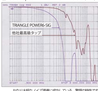
▲HP社 Network Analyzer 高周波基準ノイズ信号をインレットからタップに入力し、コンセントから出力されたノイズ信号を測定。タップを通すことでノイズがどれだけ減衰するかを測定。
